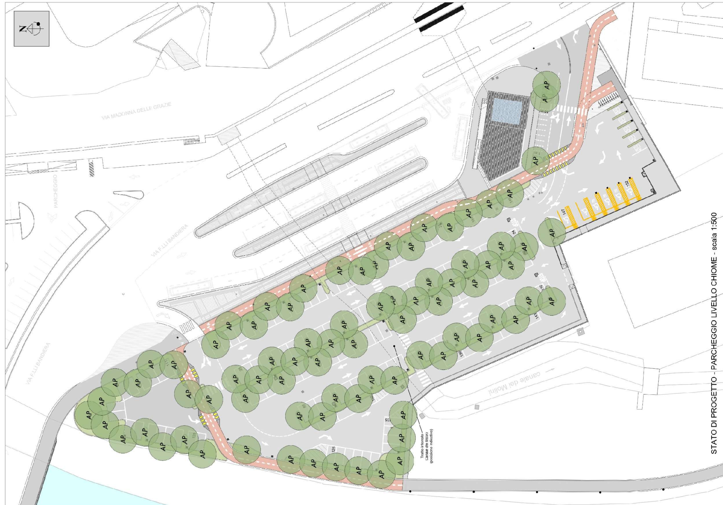
Stato di progetto a livello delle chiome del parcheggio del Plateatico – In alto a destra la palazzina servizi con la copertura fotovoltaica
